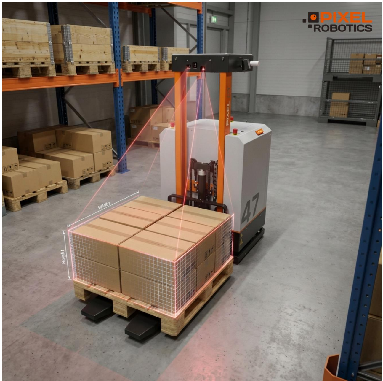
Bild : KI-Transportroboter Pixel PT: Vermessung des Ladeguts beim Transport (Quelle Pixel Robotics)
